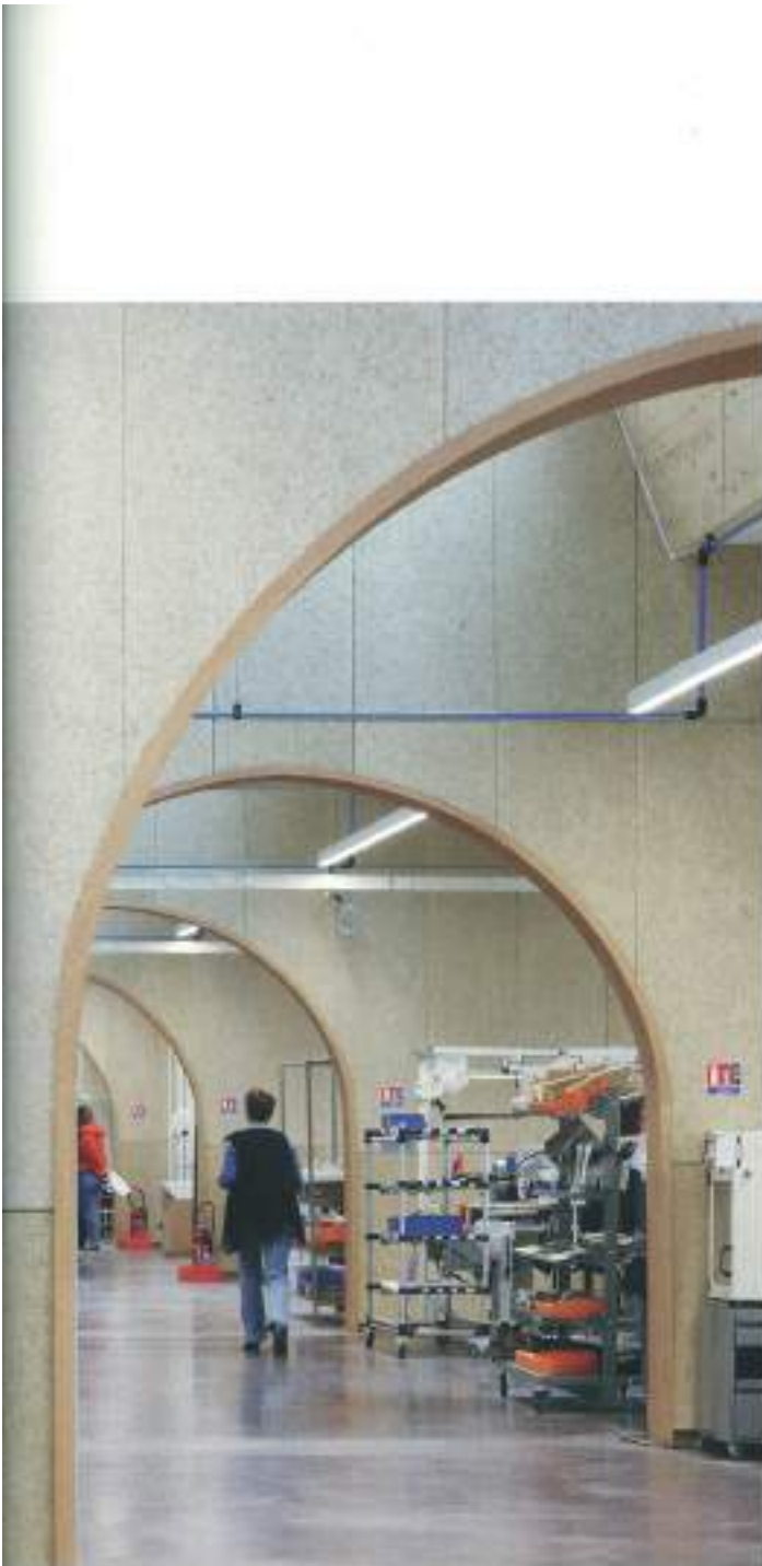
CICOUTRE. En partie nord du bâtiment, les ateliers sont installés par groupe de trois, deux ateliers d'assemblage et de couture encadrant un atelier de coupe. Ils sont largement éclairés latéralement par les arches vitrées en façade nord et pénétrativement par les rangées de sheds en toiture. Les parois sont recouvertes de panneaux en fibre de bois fibré afin d'assurer le confort acoustique. Les besoins en électricité, chauffage et climatisation sont assurés par la ventilation naturelle, le géothermie et 2 300 m 2 de panneaux photovoltaïques pour une totale autonomie énergétique.
